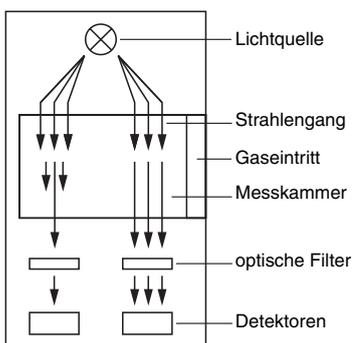
Das NDIR Sensorelement besteht aus einer Lichtquelle, optischen Bandfiltern und Detektoren. Die Lichtquelle emittiert pulsierend ein breitbandiges Spektrum. Die Strahlen durchqueren die Messkammer. Der zu überwachende Stoff dringt in diese über Diffusion ein.
